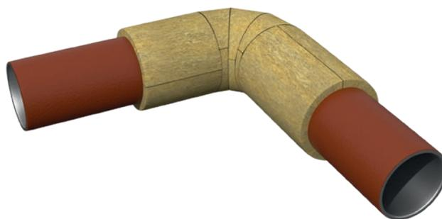
Схема изоляции отводов и тройников малых диаметров
