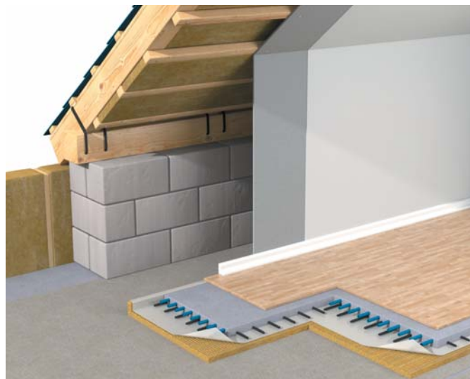
Схема утепления кровли
