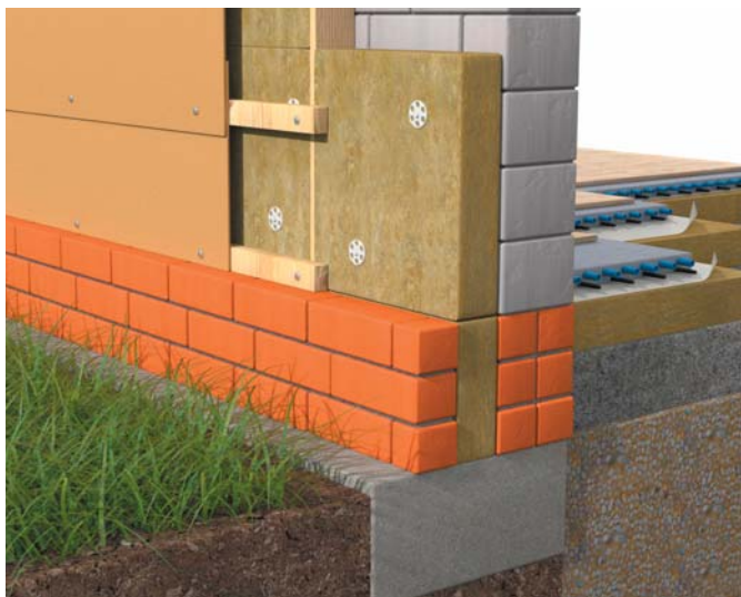
Схема утепления фасадов и пола
