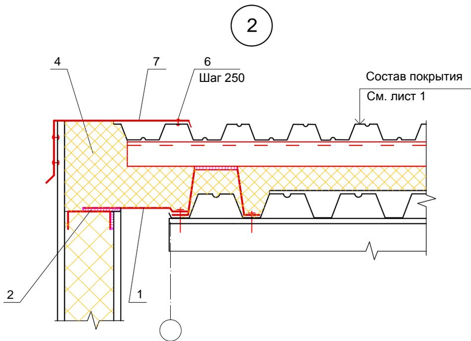
1. Оцинкованная сталь  $\delta=0,8$  мм.
