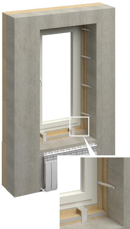
Конденсат может образовываться при температуре поверхности откоса +11 °C и ниже (в жилом помещении с температурой воздуха +20 °C и влажностью 60 % в отопительный период).
