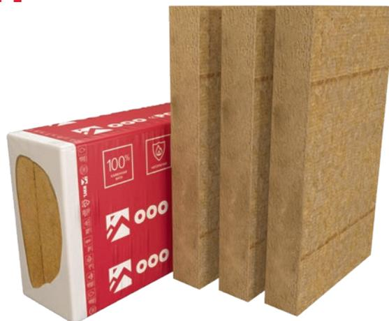
Плиты из каменной ваты ФАСАД БАТТС БАЛКОН используются в качестве теплоизоляции фасадов с тонким штукатурным слоем на малоэтажных зданиях (Не более 3-х этажей\*) с пониженным классом надёжности СК2, а также на участках стен, не подвергающихся внешним воздействиям (застекленные лоджии, балконы, лестничные клетки), на внутренних поверхно-
