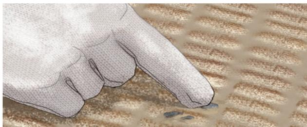
1. Необходимо проверить поверхность теплоизоляционных плит на предмет наличия инородных включений и удалить при их наличии.
