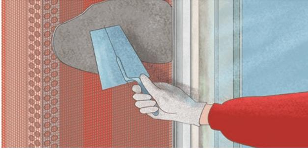
5. Далее в этот профиль заводится армирующий слой РОКмортар с сеткой от армирующего уголка. Если сетки от армирующего уголка и профиля примыкания недостаточно для перехлеста, необходимо вырезать полосу сетки РОКфайбер-Б для обеспечения полного армирования откосов и их угловых частей.
