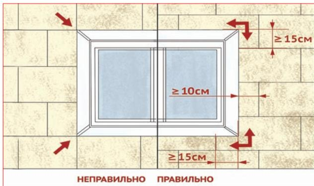
15. Обрамление оконных и дверных проемов осуществляется с помощью плит с подогнанными «по месту» вырезами. При этом стык плит не должен совпадать с линией откоса. Монтаж осуществляется из цельной плиты, из которой вырезается часть не менее 15 см по горизонтали и по вертикали.
