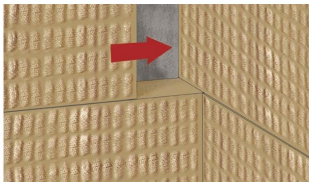
14. Монтаж плит на внутренних углах осуществляется с перевязкой вертикальных стыков.
