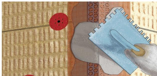
2. Для достижения ударной устойчивости все наружные углы армируются специальным угловым профилем ПВХ с сеткой. Для этого после предварительного втирания смеси базово-клеевого, на поверхность смонтированных плит площадью чуть большей площади профиля с сеткой наносится смесь базово-клеевого состава слоем около 2 мм, в который утапливается армирующий уголок легким движением гладкой стороны шпателя.
