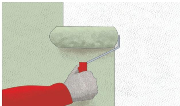
9. Окраска фасадов. Поверхность, выполненная минеральной штукатуркой, подлежит окрашиванию. Окраска производится валиками или кистью не ранее чем через 7 суток после нанесения штукатурки. Для окраски используется силиконовая фасадная краска с высокой паропроницаемостью. Окрашивание производится в два слоя.
