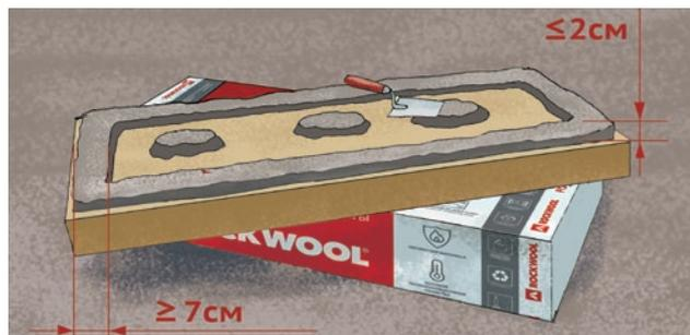
3. Клей ROCKglue наносят на обработанную поверхность утеплителя при помощи кельмы, создавая «бортик» шириной не менее 7 см с отступом от края плиты не менее 2–3 см и 3–8 крупных точки (диаметр не менее 5 см) в середине плиты. Высота слоя нанесенного клея должна составлять не более 2 см. После установки теплоизоляционной плиты в проектное положение площадь адгезионного контакта между плитой и основанием должна составлять не менее 40 % от площади плиты.
