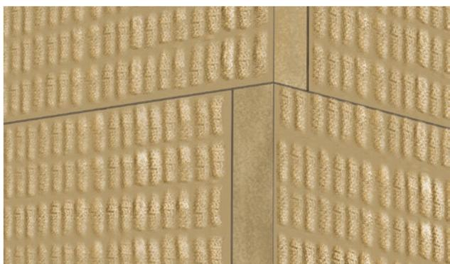
11. Монтаж плит на внешних углах осуществляется с перевязкой вертикальных стыков.
