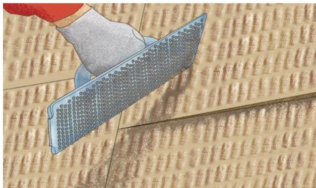
16. Смонтированные плиты должны находиться в одной плоскости. В случае обнаружения неровностей не более 2-4 мм на поверхности их следует отшлифовать специальной теркой. Выравнивание неровностей за счет увеличения толщины базового армировочного слоя не допускается.
